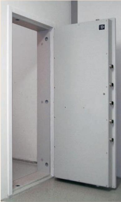
Die Wertraumtür PORTA eignet sich für Waffenräume, entweder durch nachträglichen Einbau in vorhandene Räume oder durch rechtzeitige Planung bei Neubauten. Die mehrwandige Zarge ist durch spezielle Bohrungen für die Befestigung im Mauerwerk vorbereitet und wird wahlweise als Block- oder Eckzarge gefertigt. Wertraumtüren sind außen angeschlagen, wahlweise links oder rechts.
